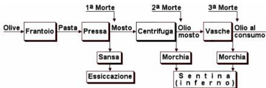
Fig. 16 - Il processo di estrazione dell'olio dalle olive.
